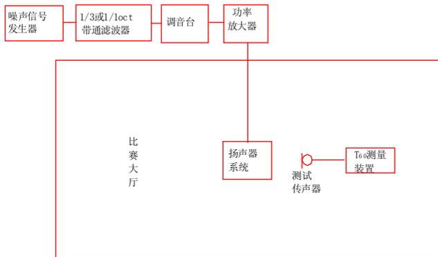
图 5.4.6 混响时间测量方框图
