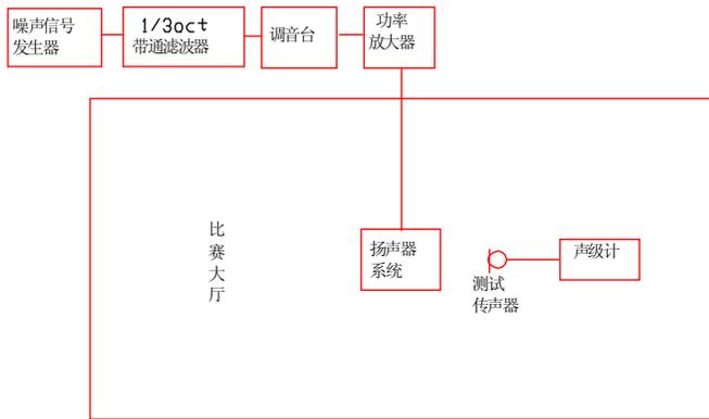
图 5.4.1 传输频率特性测量方框图
