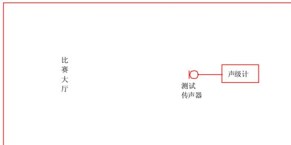
图 5.4.5 背景噪声测量方框图
